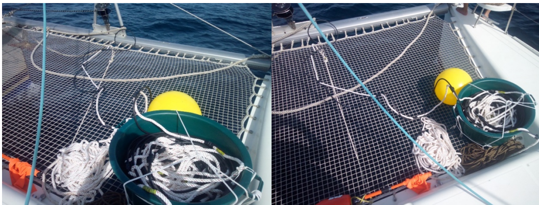
Figure 5. Photos de l'hydrophone tracté et déployé à l'avant du bateau.
